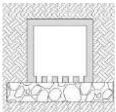
*Pozzetto (in calcestruzzo, plastica, polietilene, ecc.) di dimensioni circa (50 x 50 x 50) centimetri aperto nella parte inferiore e posato su uno strato di ghiaia grossa di 10-12 centimetri di spessore.*
